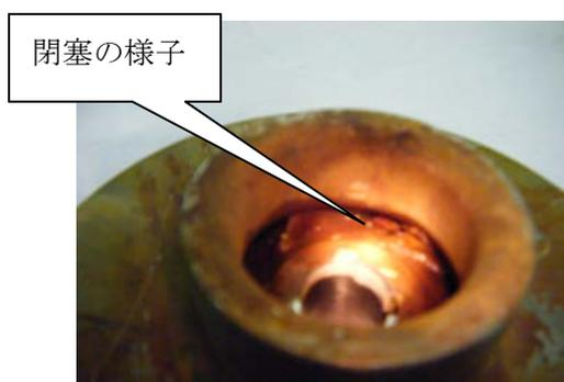
図5 流路が閉塞したインペラーの様子
