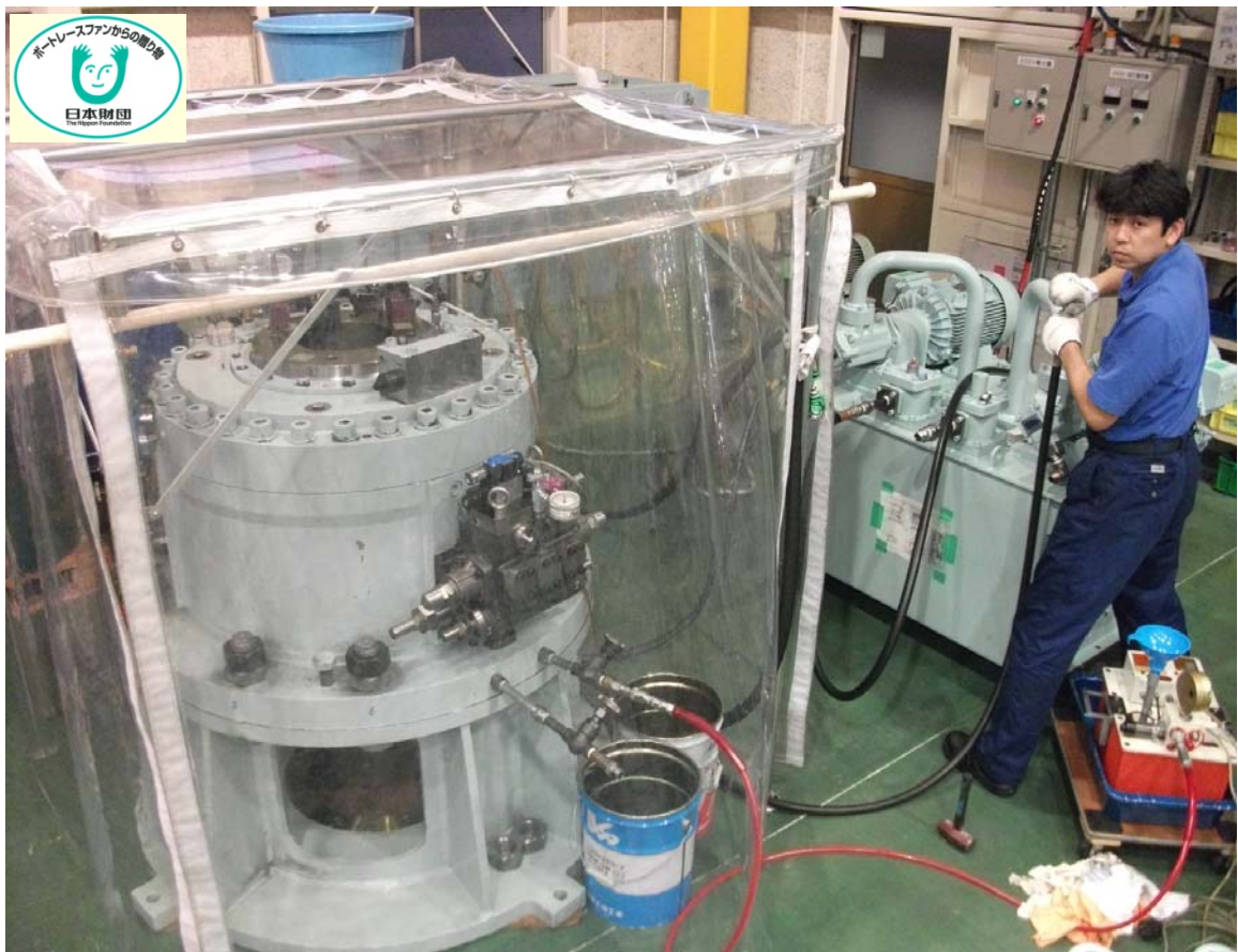
写真 4.1.4-1 試験機の単独試験のためのアクチュエータ（左）とポンプユニットの結合作業（蚊帳状に掛けた透明フィルムは耐圧試験時の保護用カバー）
