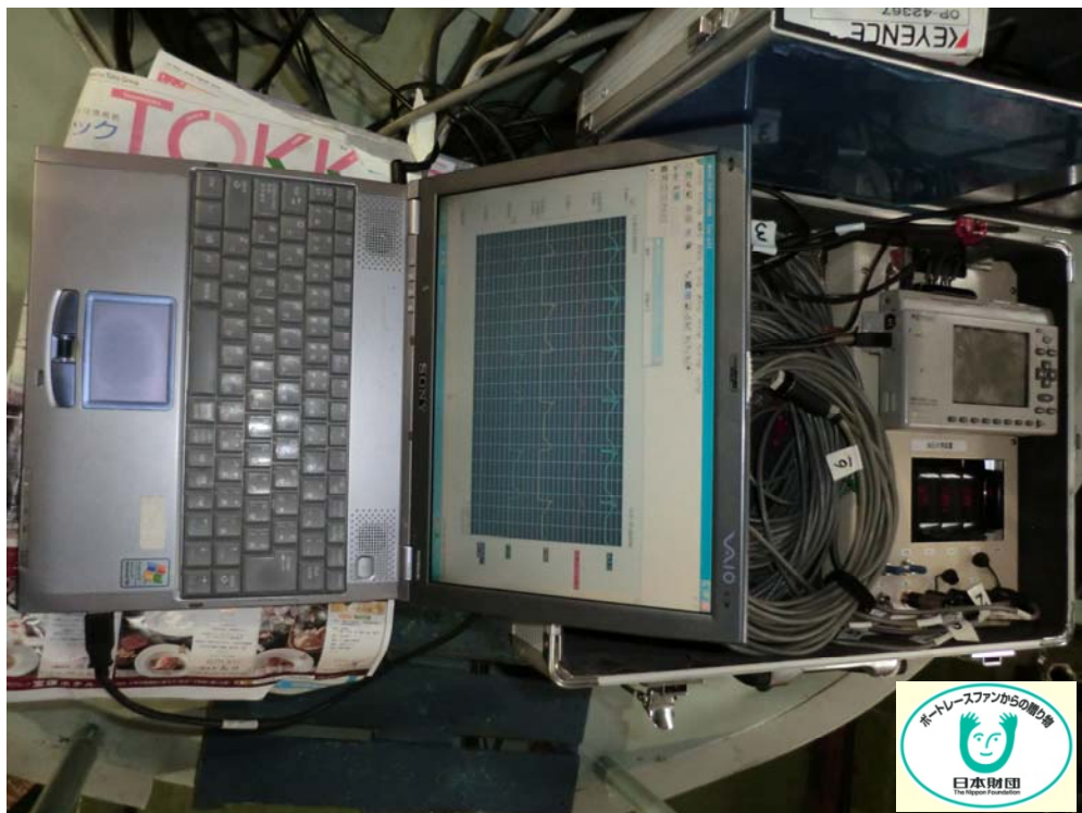
写真 4. 1. 4-9 各部圧力及び舵角の連続記録装置
