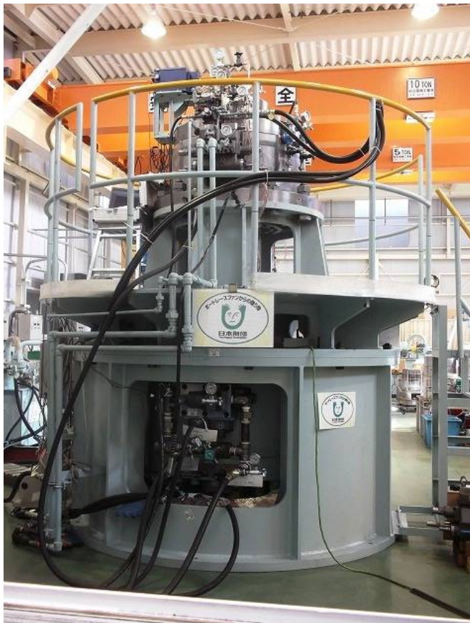
写真 4.1.4-11 写真 4.1.4-10 の裏側（負荷弁側）から見た試験装置 (上が試験機、下部架台の中に負荷機が吊り下げられ、負荷制御弁が取り付けられている)
