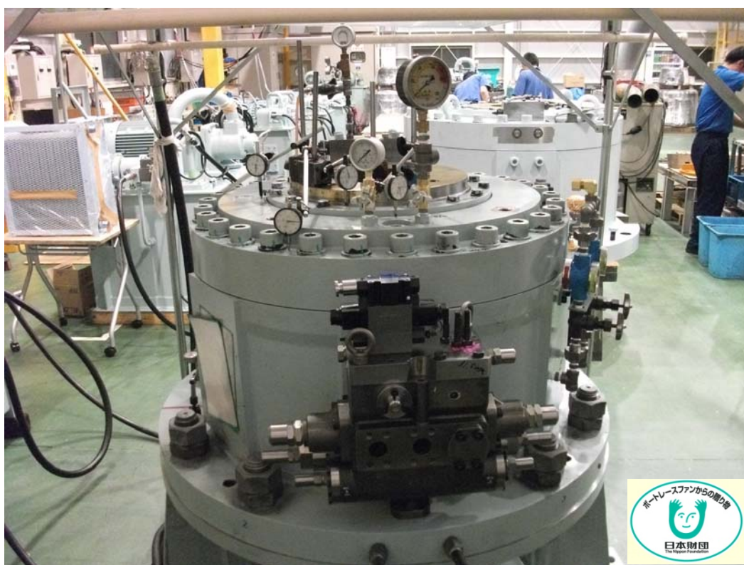
写真 4.1.4-2 試験機耐圧試験時のカバー変形計測用ダイヤルゲージ配置状況
