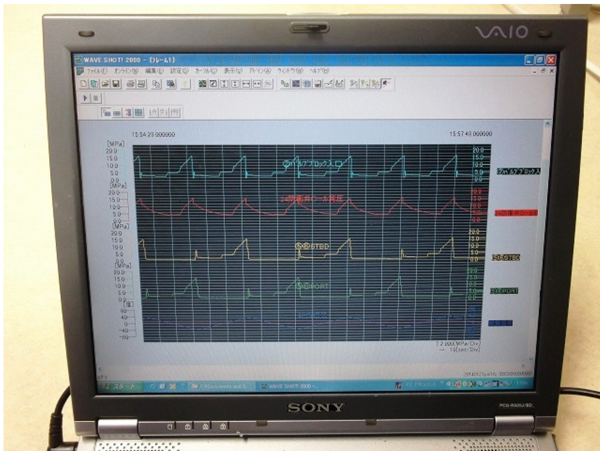
写真5.4-1 耐久試験時（舵角35にて油圧15MPa）の記録計画面
