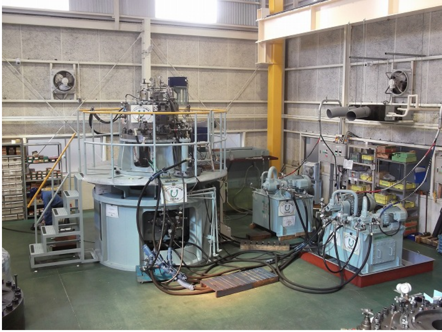
写真 4.1.4-10 試験装置の総合組立状態の全景 (左から、試験装置、負荷機用ポンプユニット、試験機用ポンプユニット)
