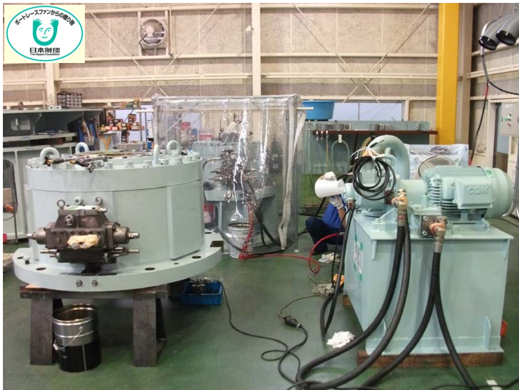
写真 4.1.4-3 負荷機の単独試験のためのアクチュエータ(左)とポンプユニット(右)の結合作業
