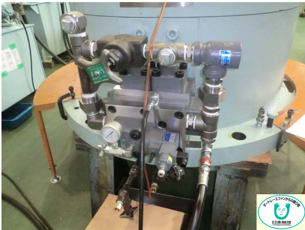
写真 4. 1. 4-5 負荷機への比例電磁制御リリーフ弁ユニットの組付け
