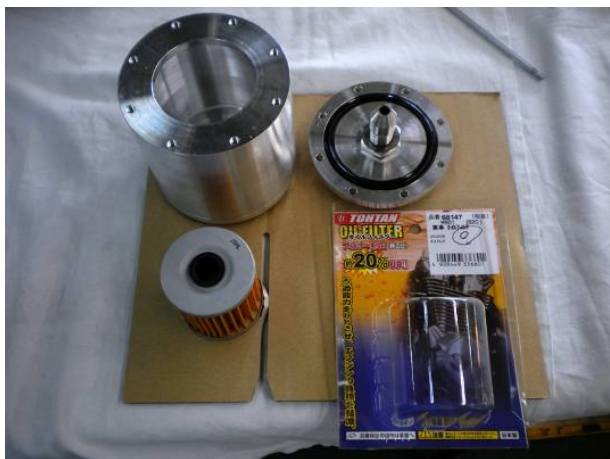
図 4.3.1.5 フィルターの構成
