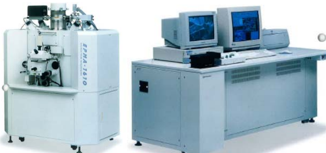
図 4.4.1.1 材料分析装置 (EPMA-1610)
