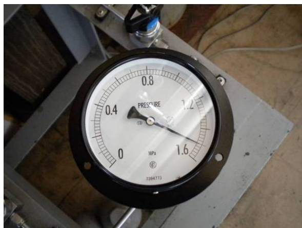
図 4.2.15 15 分後の圧力表示
