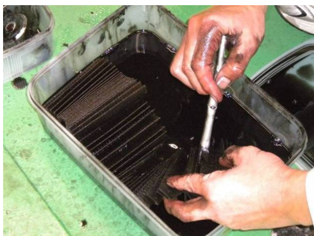
図 4.4.2.3 フィルターからの掻き落とし作業
