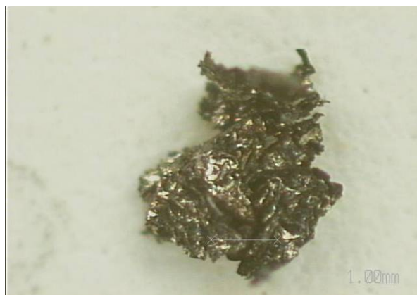
図 4.3.2.7 鉄粉付着した炭素
