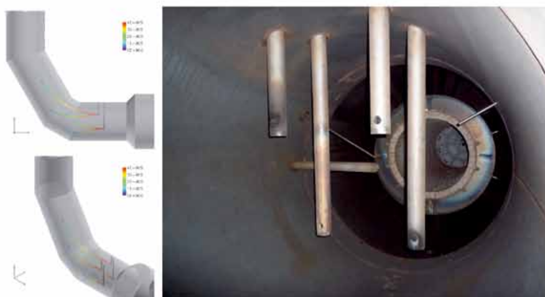
図 6.1.3.5 還元剤噴射ノズルユニットCFD解析(左図)、ノズル概観(右図)
