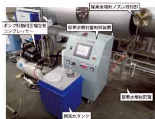
図 77 尿素噴射装置外観(一流体ノズル)
