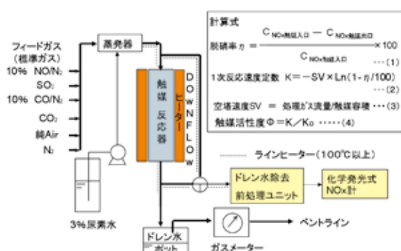
図 34 固定床小型流通式触媒試験装置 (マイクロリアクター)
