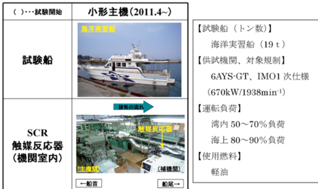
図3-1 実船試験船外観と触媒反応器設置状況 (小形高速主機関)
