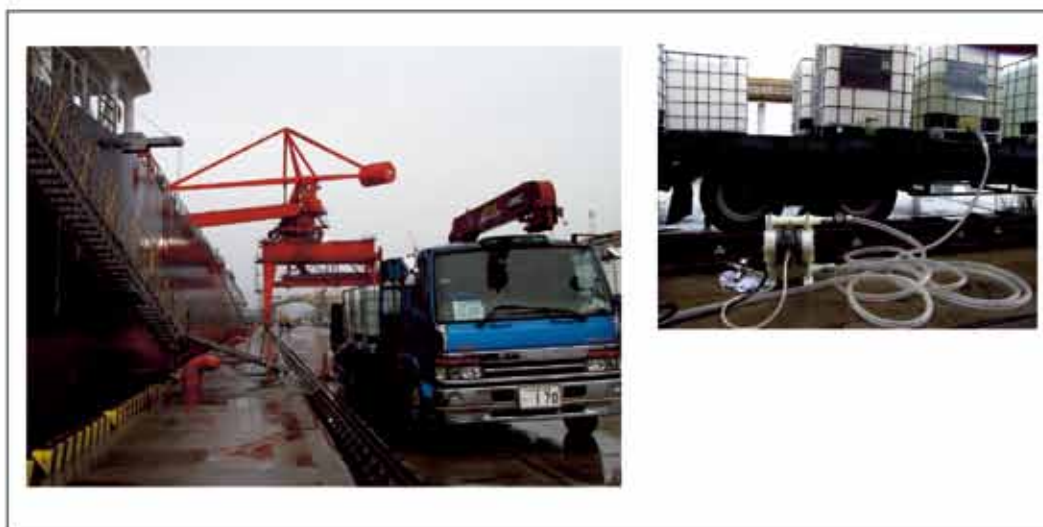
図3-25 ダイアフラムポンプによる尿素水補給状況
