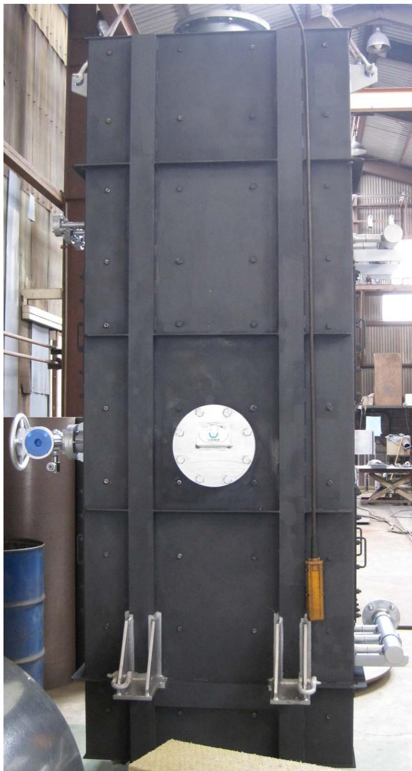
図43 排熱回収型サイレンサ
