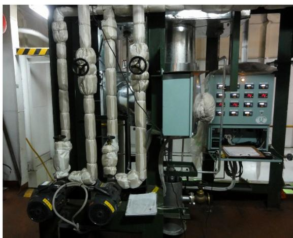
図61 試験用計器盤
