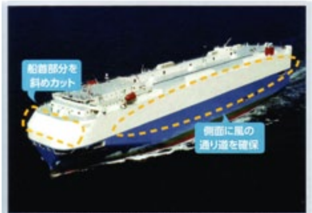
風の抵抗を減らした自動車運搬船 (写真提供: 高船三井)
