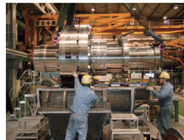
大容量油圧クラッチ試作機下ケーシングへの組み込み作業中
