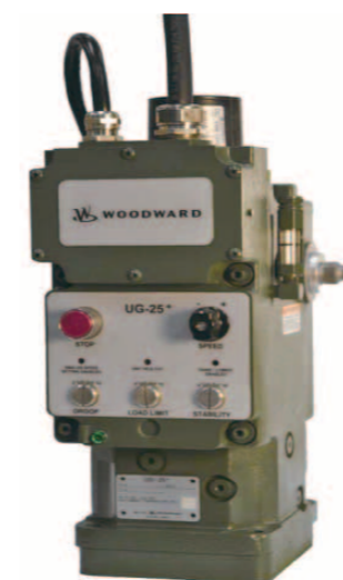
Woodward UG-25+ Governor UG25+ガバナは、ディーゼル・エンジン、ガス・エンジン、デュアル・フェューエル・エンジン及び蒸気タービンの制御を行う、マイクロプロセッサ制御の機械油圧ガバナです。
