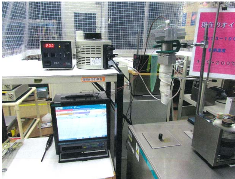
図 2.5 リボンヒータによる（200℃超）加熱試験設備
