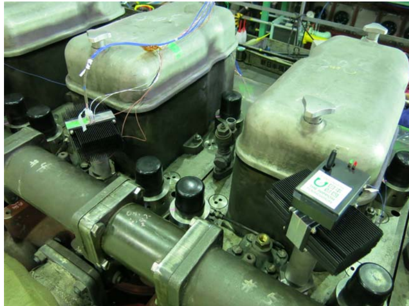
図 5 2 左：4cyl 設置の計測用センサ（L100）、右：5cyl 設置の供試体(L150)
