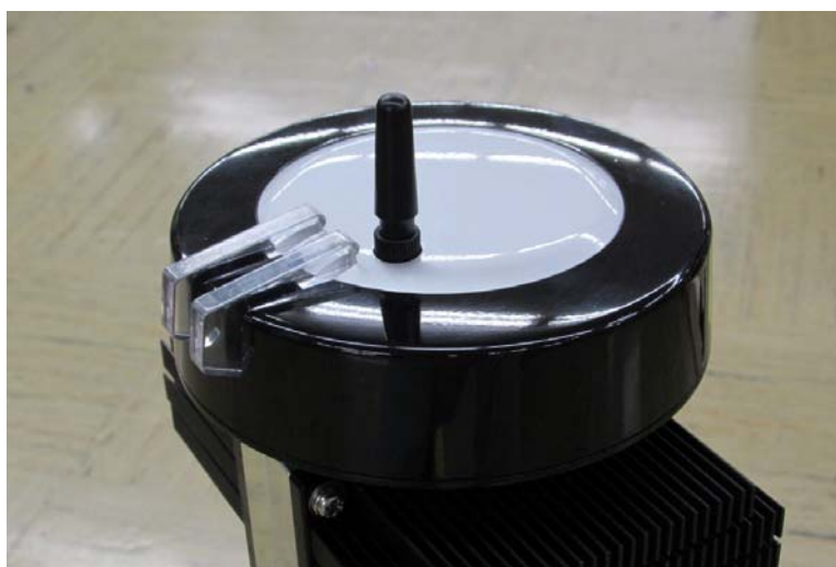
図 3 0 最上部にある基板収納ケース（直径 130mm×高さ 38mm）
