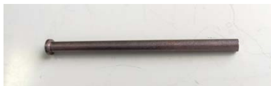
図 1 9 放熱側（第二伝熱部部品）銅/グラファイト焼結材（熱伝導率 \lambda = 630 ）
