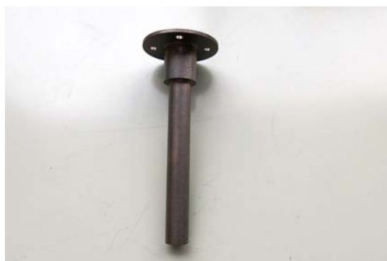
図 1 8 集熱側（第一伝熱部部品）銅/グラファイト焼結材（熱伝導率 \lambda = 630 ）
