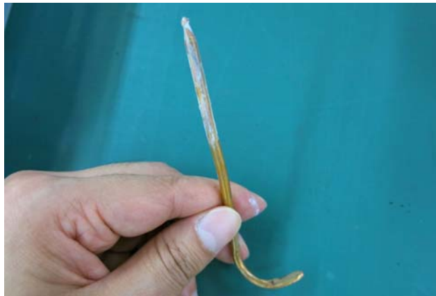
図 2 1 放熱側（第二伝熱部部品） ヒートパイプ（熱伝導率 \lambda = 約 10000）
