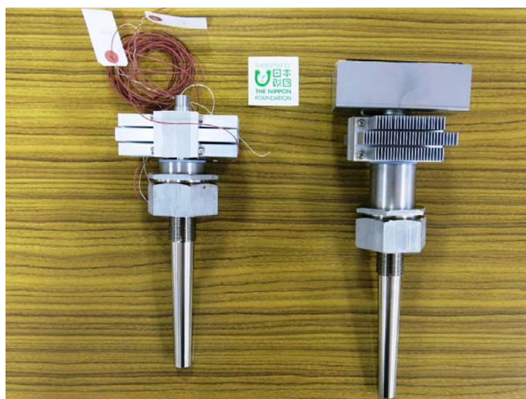
図 2.3 左：各部温度計測用センサ、右：首長さ 50mm の熱電発電無線温度センサ
