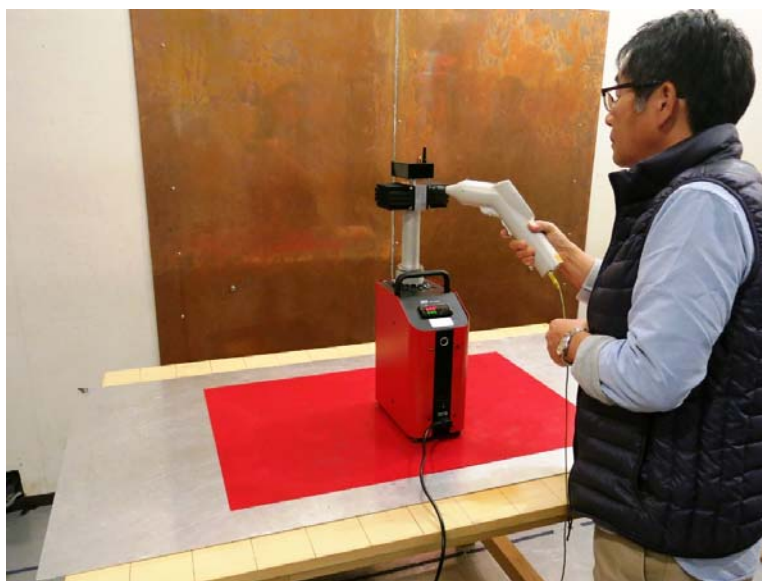
図 6 9 静電気発生器にて、供試体へ静電気を掛けているところ
