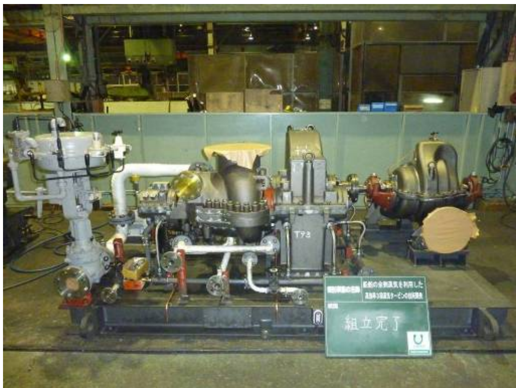
図 4-46 蒸気タービン組立完了
