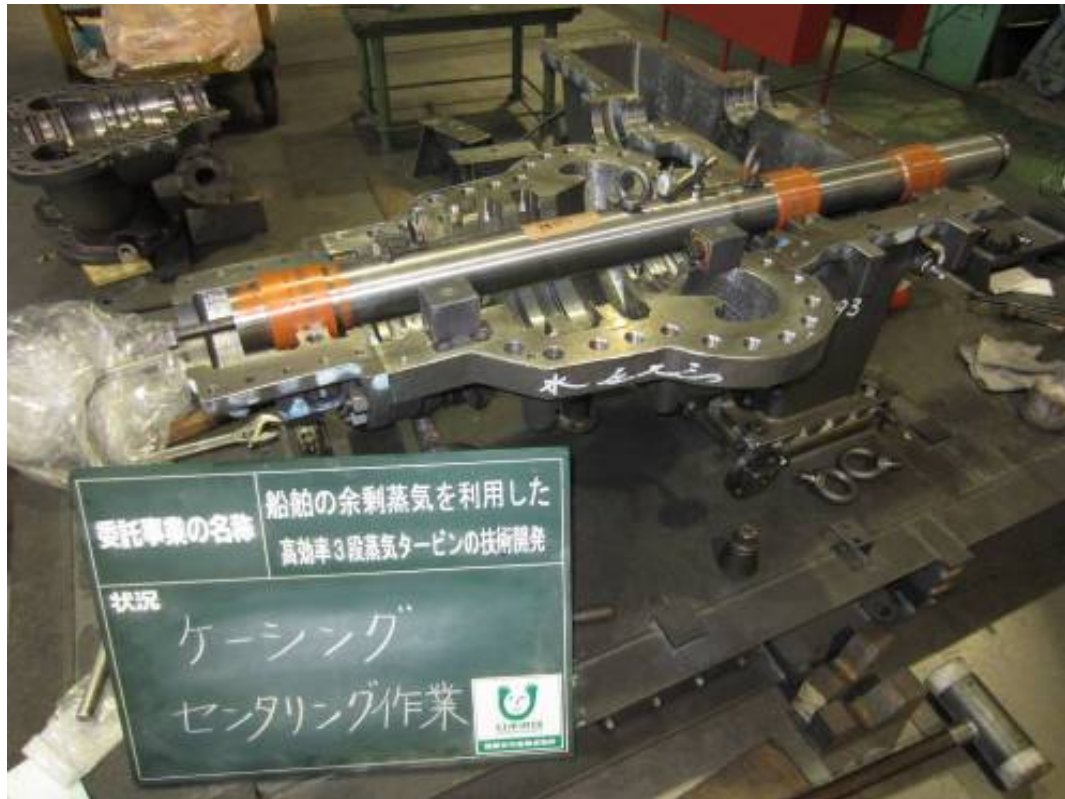
図 4-32 ケーシングのセンタリング作業
