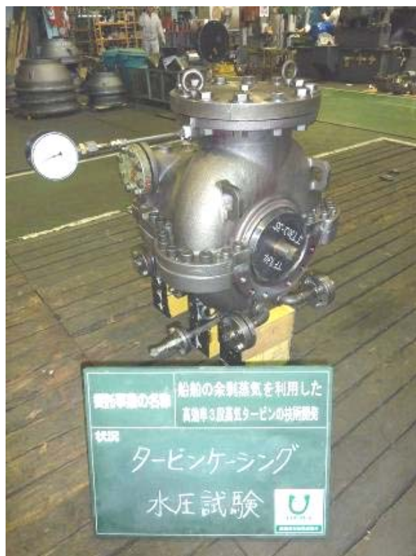
図 4-26 タービンケーシング水圧試験中
