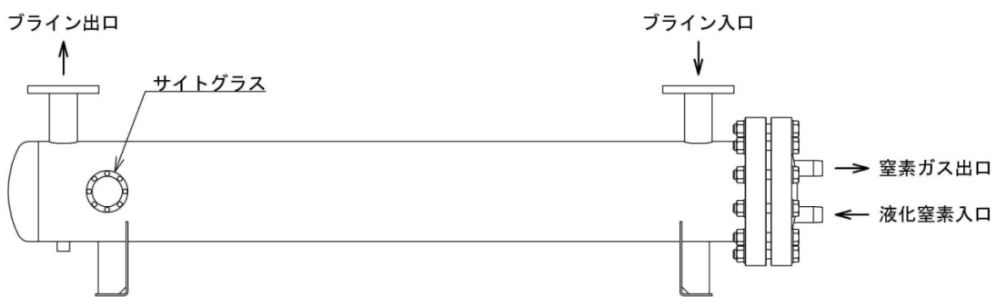
図 5. 1. 4 冷熱回収熱交換器の外形図
