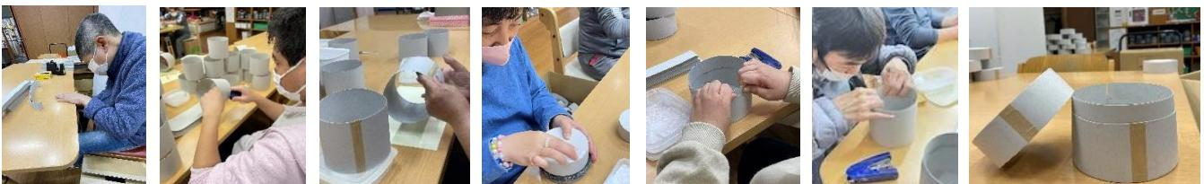
丸箱の製作には、特別に発注した資材を用いて、カーブ付けから始まり、ホッチキス止め、それを隠す茶テープ貼り、ボンド付け、内枠貼りの工程を経て完成します。もくもく独自の道具を使いながら誰もが携われるよう工夫して取り組んでいます。
