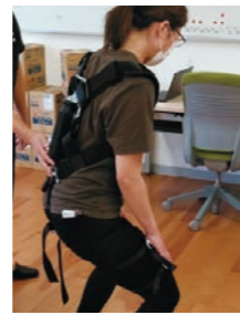
背中から腰に装着して使うパワーアシストスーツ
