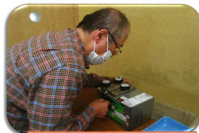
銅線剥離（機械通し作業）
