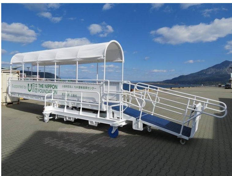
バリアフリー対応型タラップ 三島村向け 1基 L9900×W2000× H最低 850/最高 3900 mm
