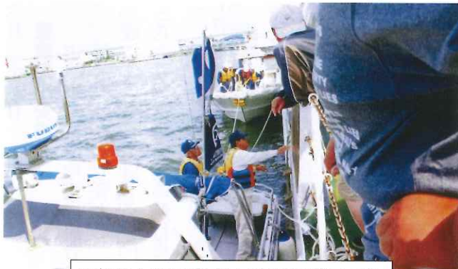
曳航船と被曳航船との間に簡易ペンダントを使用しての曳航方法実習
