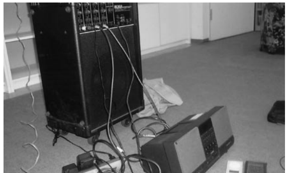
〈アンプ〉伴奏用に使用する。音源（キーボード、伴奏機、MD、CDなどの音量を増幅）など調整します。〈伴奏くん〉フロッピー使用。キー、テンポが瞬時に変えられます。赤ちゃんのテンポ、お母さん（赤ちゃん）の歌いやすい声の高さに合わせられます。
