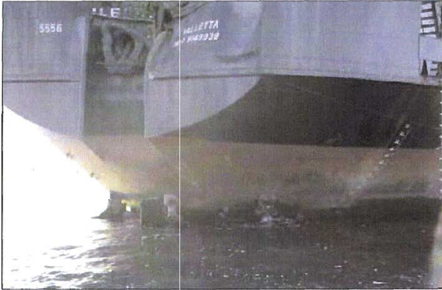
図8 イレクサ号船尾、中心線上の舵と左舷右舷のノズル
