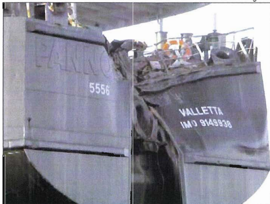
図5 イレクサ号の船尾の損傷状況
