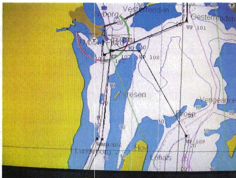
写真は、カレン・ダニエルセン号の計画予定航路と本船G P S 航海計器に記録された実航跡を示している一スベンドボルグ港入・出航路。
