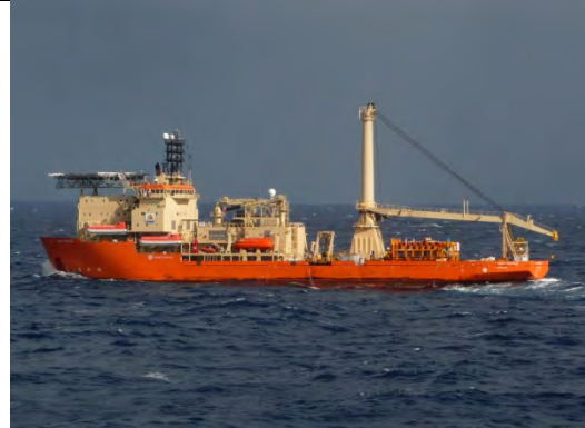
CSV - Construction Support Vessels-1 オフショアサポート船の中では大型の船舶となる。海上での設備建設、搭載工事、メンテ、修理等の目的で使用
