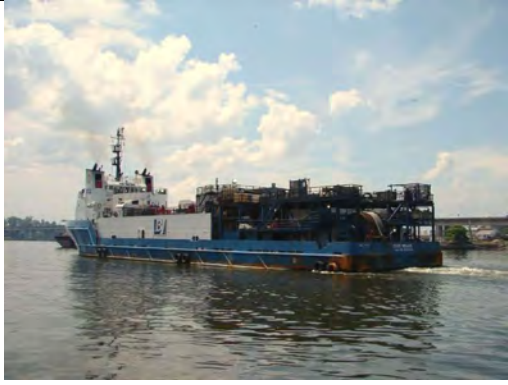
Well Stimulation Vessel 操業中の海洋設備の生産性を向上させたりモニタリングするなどの役割を持つ。
