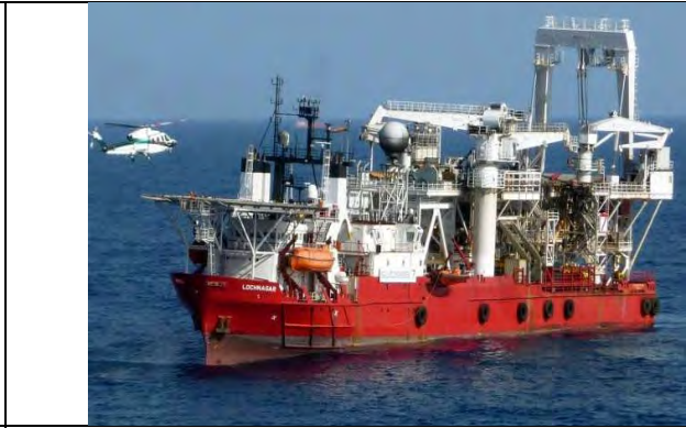
PLSV - Pipe Laying Support Vessel CONSTRUCTION/FLEXLAYNG/PIPE LAY パイプハンドリング作業を行う
