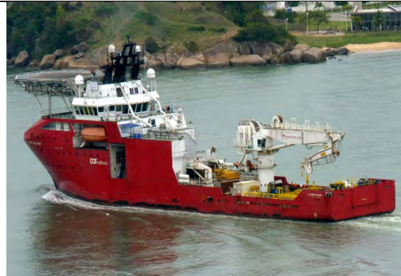
CSV - Construction Support Vessels-1 オフショアサポート船の中では大型の船舶となる。海上での設備建設、搭載工事、メンテ、修理等の目的で使用
