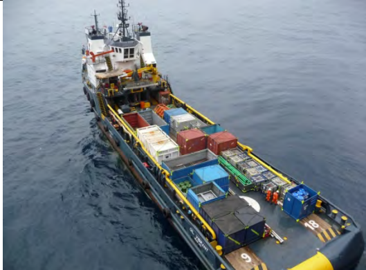
MPSV - Multipurpose Supply Vessel 貨物やアンカーなどのハンドリングを行う。
