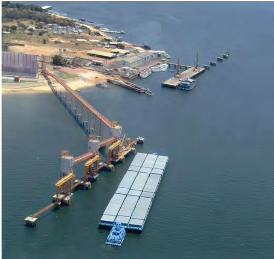
21400 トンクラスのコンボイの棧橋への接岸（9 連）
