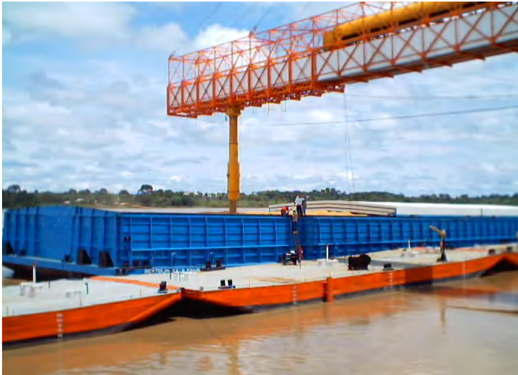
12000 トン級のコンボイ（4 連編成）とプッシャータグ
