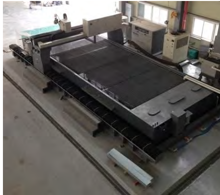
〈ウォータージェット切断設備〉
