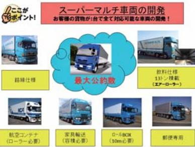
さらに、顧客のオーダーに素早く対応できるよう、さまざまな積荷に対応できる架装を施した「スーパーマルチ車両」を架装メーカーと自動車メーカーと連携して開発しました。近くに空車があっても積荷に合わない架装である場合、別の車両を手配する必要がありますが「スーパーマルチ車両」であれば、どの顧客の要望にもほぼ応じることができ、空車走行率を大幅に下げることが出来ました。その他の取組みとしては、省燃費につながる部材の使用を積極的に行いました。アルミホイールや省燃費タイヤの使用、荷台には軽量部材（竹材）を採用し省燃費につなげています。
