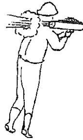
2 発射スイッチを押したがロケットは飛び出さず、内部で燃焼したため、ランチャーが前進しようとし
