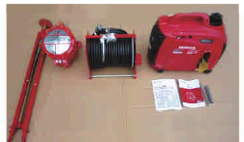
消防・排水ポンプ
