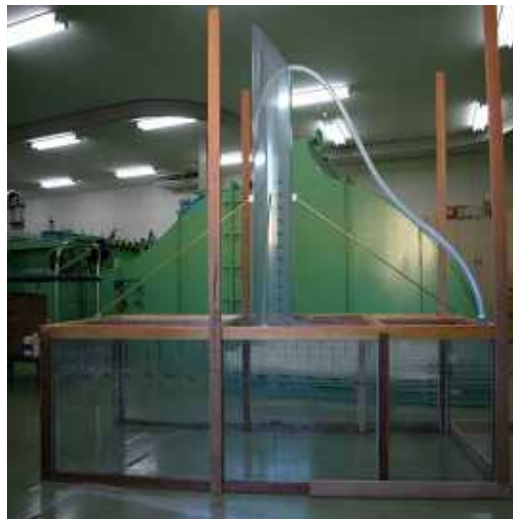
シーチェスト模型と空気吹出しの様子
