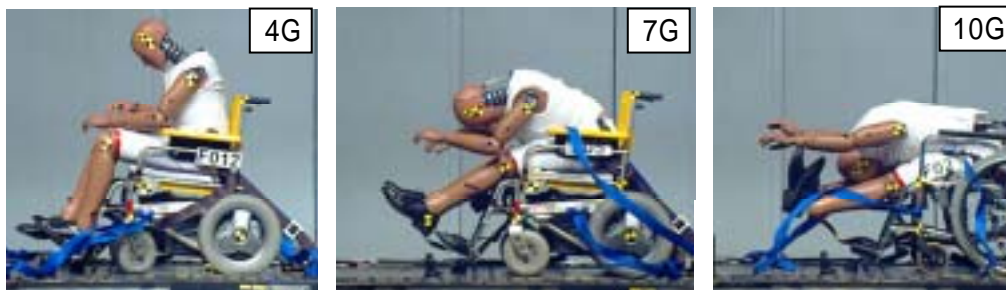
図 3.2 前向き実験におけるスレッド加速度別のダミーの前屈状態の比較
