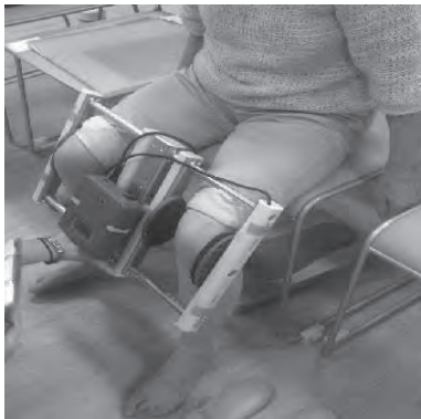
図2 膝間力計測器の外観
