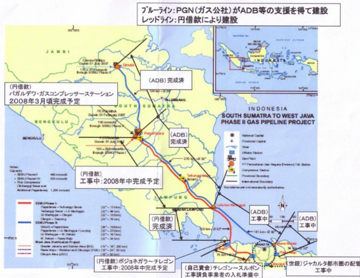
図 23 南スマトラ・西ジャワガスパイプライン建設事業進捗状況（2007年12月現在）
