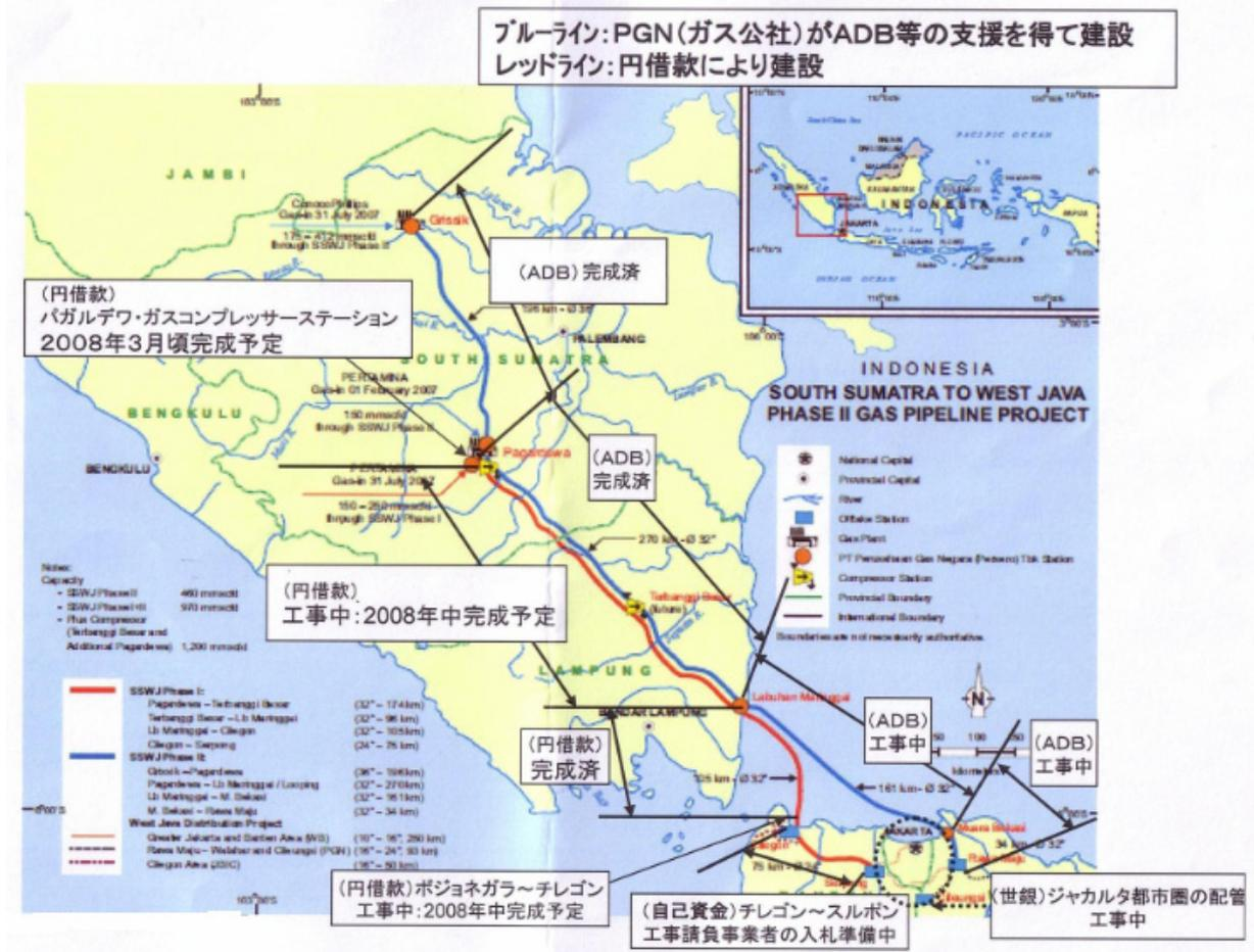
図 23 南スマトラ・西ジャワガスパイプライン建設事業進捗状況（2007年12月現在）
