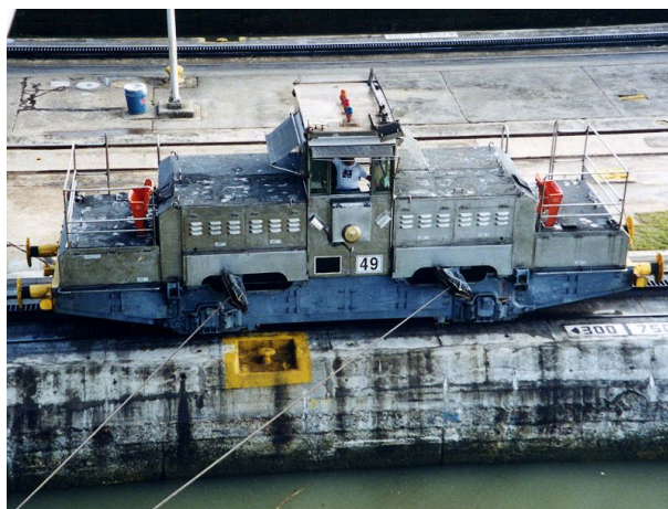
牽引電気機関車
