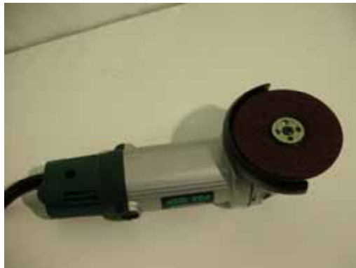
写真 7. 工程 2 ディスクサンダー (HITATI PDA - 100 F)
