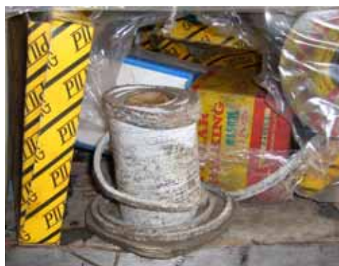
(弁グランドパッキン)
