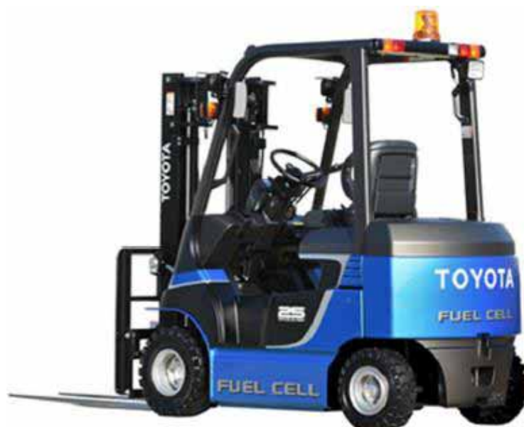
ベース車両：2.5t積 電動フォークリフト (注：塗装色・デザインは実証試験車仕様のもので)
