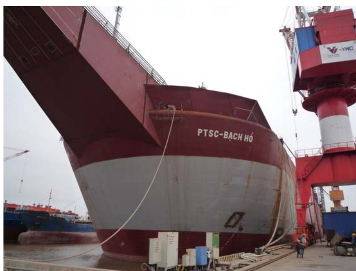
写真2 建造中の FSO(15 万 DWT)
