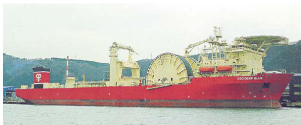
パイプ敷設船
