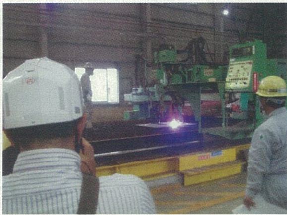
鉄板の切断作業
