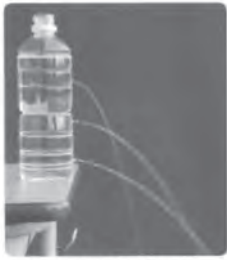
⑫ 深さと流れ出る水の勢いの関係 あな（穴）の位置が低いほど勢いよく流れ出る。
