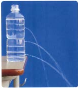
図2 深さと流れ出る水の勢いの関係 あな（穴）の位置が低いほど勢いよく流れ出る。
