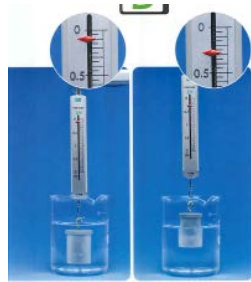
図3 浮力の大きさのちがい 物体を全て水に入れたときと半分だけ入れたときで、浮力の大きさは異なる。
