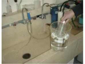
水流ポンプからの、水を吸引する管に取り付けたピペットを、ペットボトルの中に入れ、海水を吸い出します。 2リットル吸い出し、1リットル残します。
