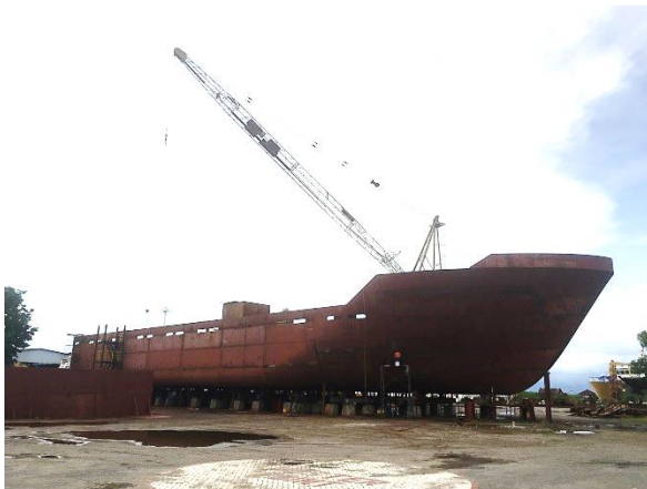
PT Industri Kapal Indonesia で建造中の 100TEU コンテナ船
