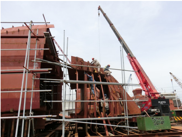
ブロック組立中
