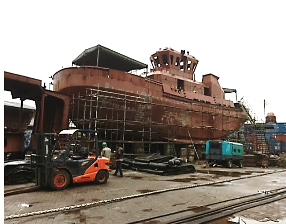
建造中のタグボート
