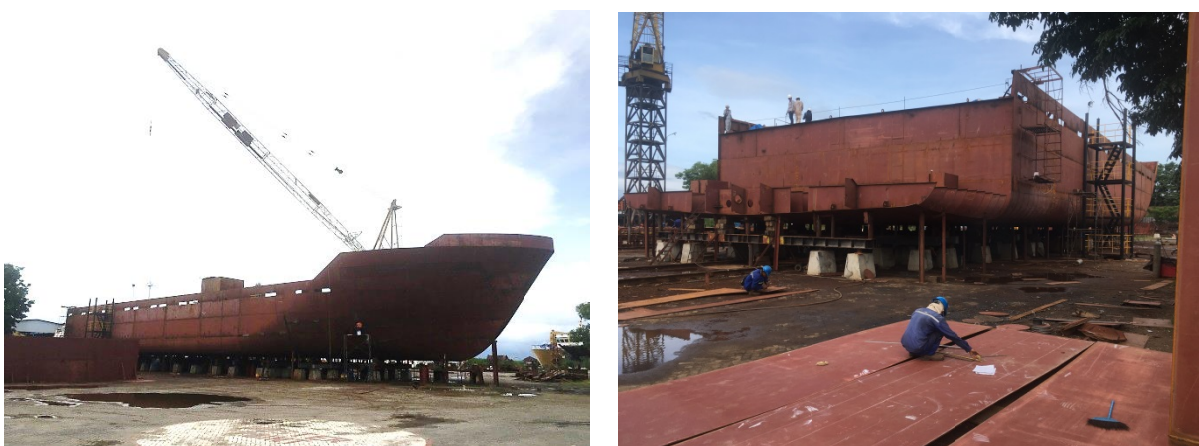
建造中の 100TEU コンテナ船（運輸省海運総局発注）
