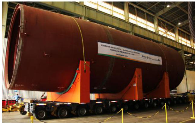
図表－ 41 Nuclep 造船所で完成した船体（SB-2/SBA-2 セクション：2016 年 12 月）
