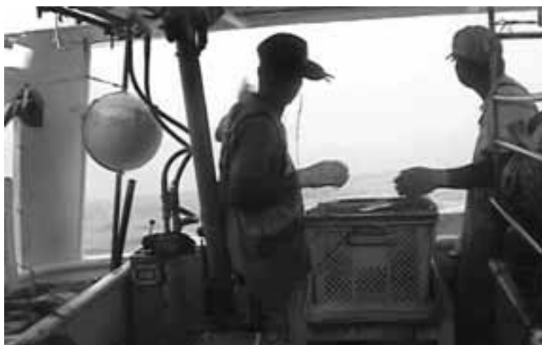
マグロ延縄の船尾から 投縄の様子。 左人後方に見えるが 投縄機。 船をゆっくり 航行しながら投縄。 (仲田吉一.2007)
