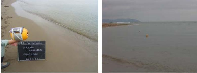
図 2-28 簡易 GPS ブイによる流況パターンの確認状況 (由良川)
