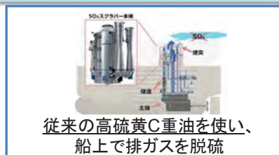
手段2 スクラバー (排ガス洗浄装置)
