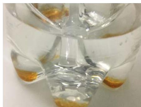
写真2 放置6時間で鉄が沈殿固液分離
