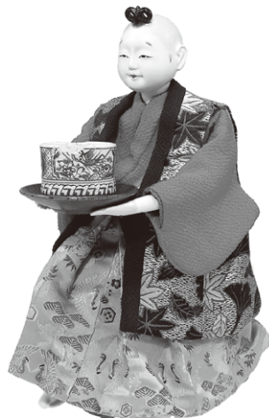
茶運び人形 1988(昭和63)年 製作:八代目玉屋庄兵衛 江戸時代のからくり人形の一つ。茶碗をおくと前進し、受け取ると帰る動きをする。この人形のゼンマイの材料には、昔からセミクジラの髪が用いられている。(横浜人形の家蔵)
