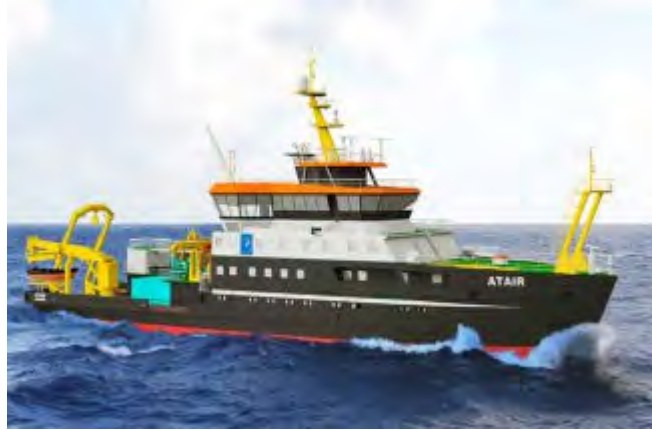
図：LNG 燃料調査船「Atair II」の完成予想図
