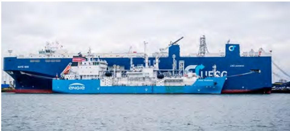
ゼーブルッヘ港における STS バンカリング (LNG バンカー船「ENGIE Zeebrugge」から UECC 自動車運搬船へ) 出所：UECC
