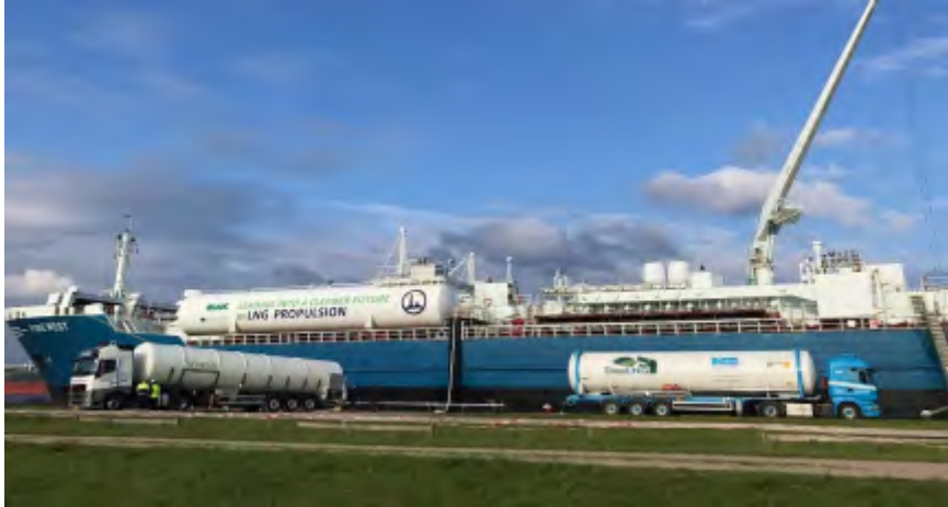
「truck-to-ship」方式（トラック 2 台からの LNG 供給）
