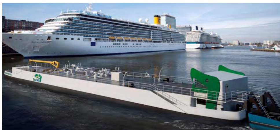
バンカーポンツーン「Titan LNG Flex-Fueler」のイメージ図
