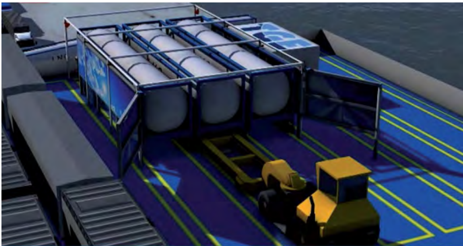
「Searoad Mersey II」の RORO 式 LNG 燃料タンクのイメージ図
