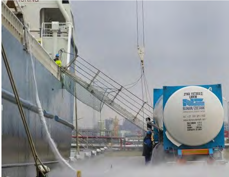
アムステルダム港：トラックによる LNG バンカリング
